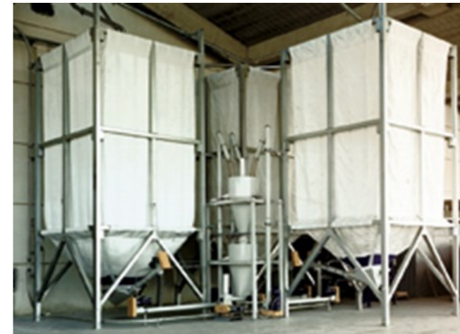
SILOFLEX Silos in Poliestere alta Tenacità Polyester Fabric
